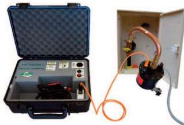
송신기의 공진기탱크(음파발생기)를 가스미터박스에 연결시킨 모습
